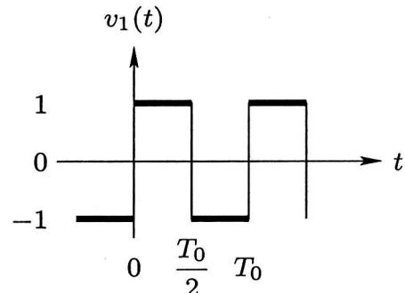
a.) Állandósult állapotú AC probléma. Először meg kell határozni a  $v_1(t)$  Fourier sorát!
