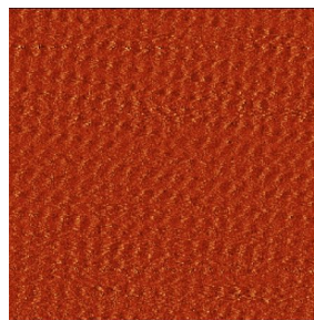
2. ábra. A kép mérete: 4,3 nm * 4,3 nm, Gwyddion programmal megjelenítve, Topography Forward nézetben, Gwyddion.net színezéssel
